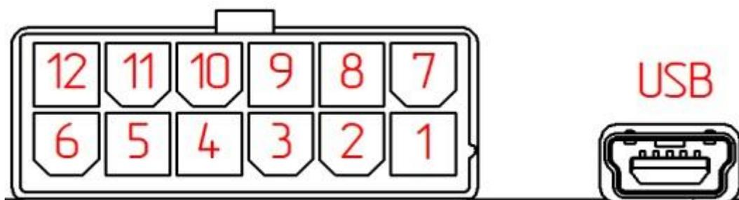
Рисунок 2 - Нумерация контактов терминала ГлонассSoft УМКа 300
