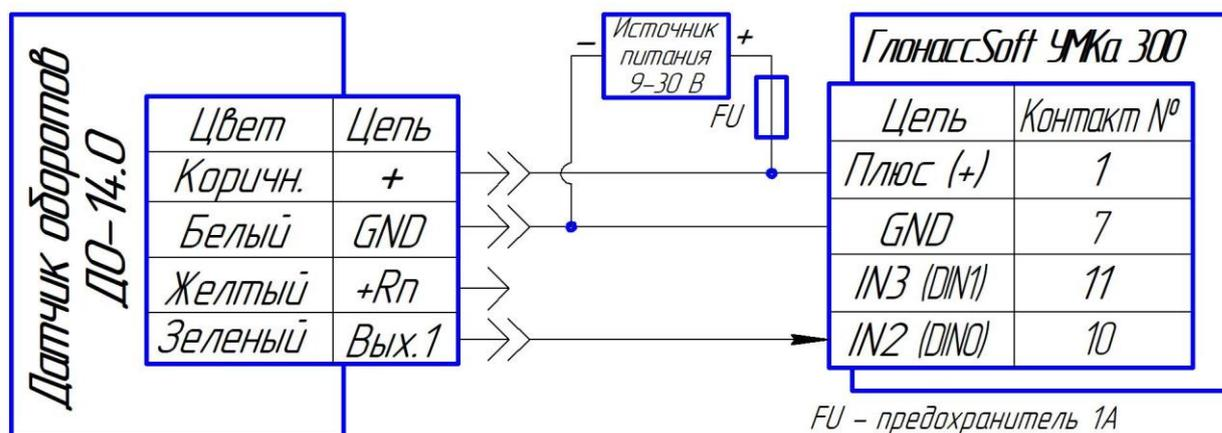
Рисунок 1 - Схема подключения датчика ДО-14.0 к ГлонассSoft УМКа 300
